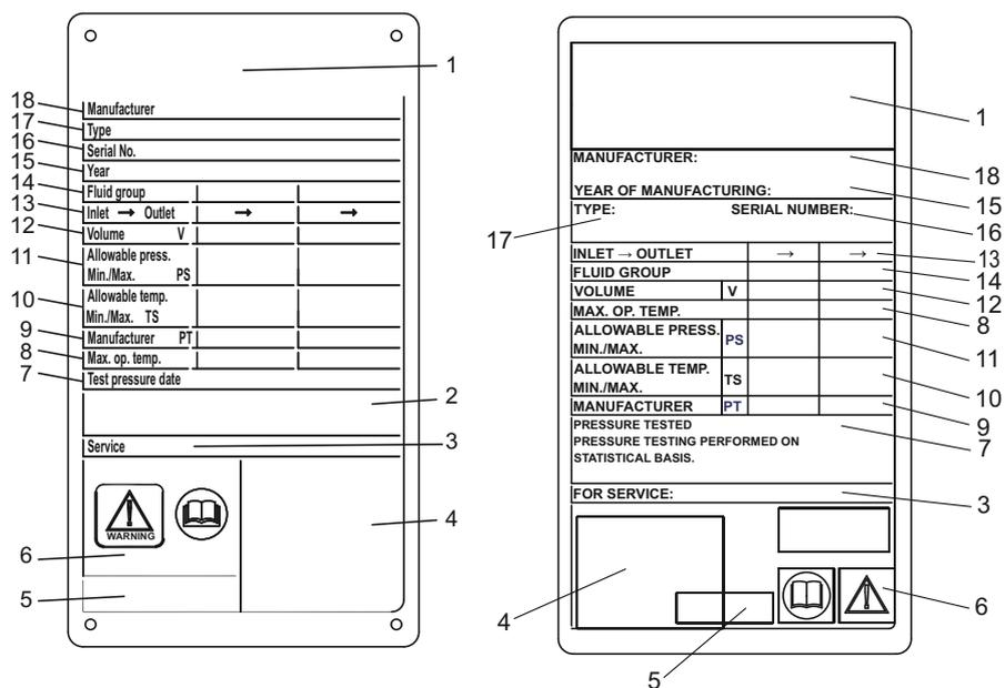
**1. attēls: Pa kreisi — metāla datu plāksnītes piemērs, pa labi — uzlīmes datu plāksnītes piemērs**
