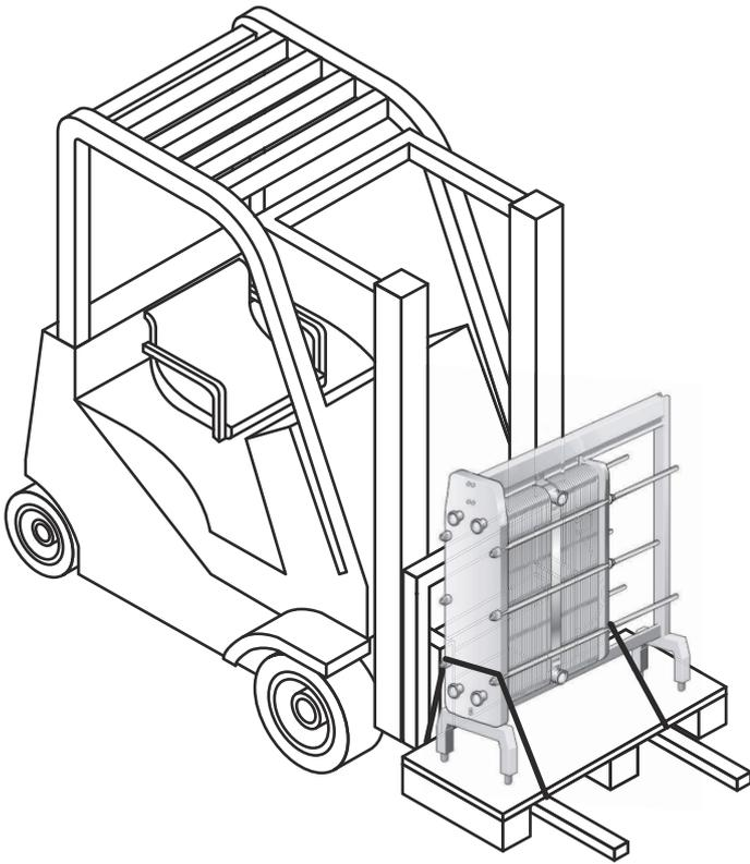
Pirms aprīkojuma atbrīvošanas no paletes nodrošiniet aprīkojumu pret nokrišanu, izmantojot celšanas cilpas.
