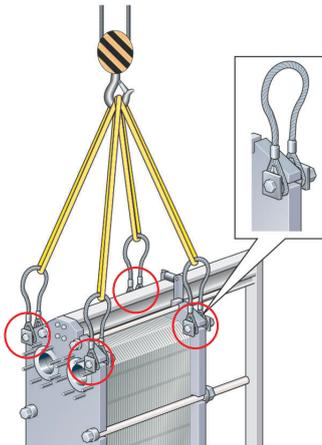
**Figure 6 : Dispositif de levage pour les modèles AQ14 et AQ14S. Le matériel de fixation est nécessaire.**
