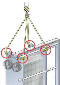
**Figure 7 : Dispositif de levage pour les modèles AQ18 et AQ14L. Le matériel de fixation n'est pas nécessaire.**
