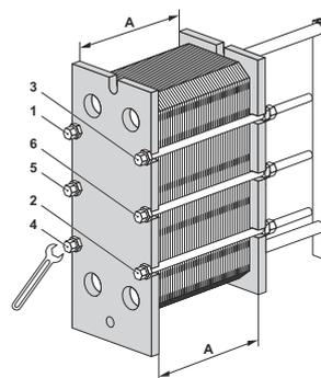
Pour le serrage manuel, une estimation du couple de serrage doit être effectuée.
