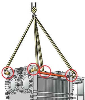
**Figure 8 : Dispositif de levage pour le modèle AQ20. Le matériel de fixation est nécessaire.**
